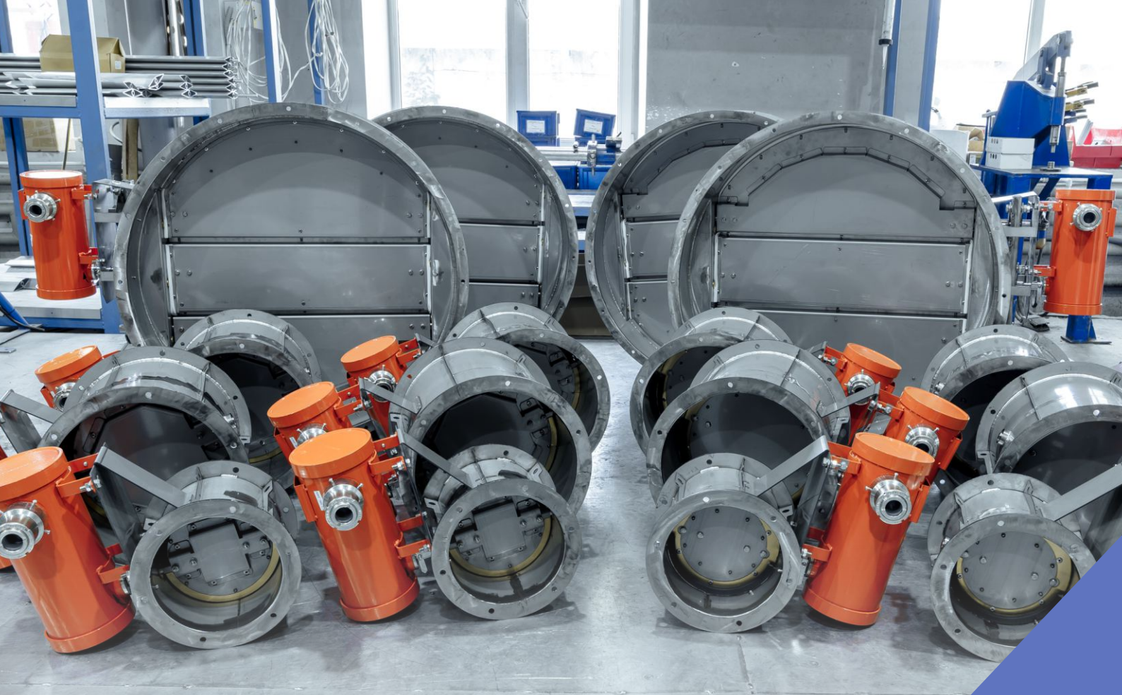
На фото клапаны высокой плотности модели М из нержавеющей стали во взрывозащищенном исполнении
